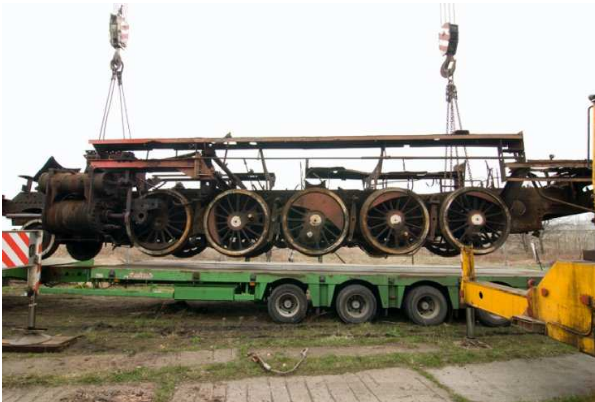
Fot. 5) Ostoja z zestawami kołowymi. Brak wiązarów i korbowodów (całego mechanizmu napędowego parowozu Ty2-1035).
