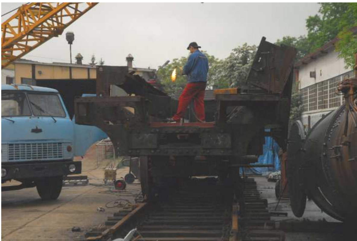
Fot. 4 ) Przykład niszczenia parowozu Ty2-1035. Zdemontowany kocioł parowozu leży po prawej stronie na zdjęciu.
