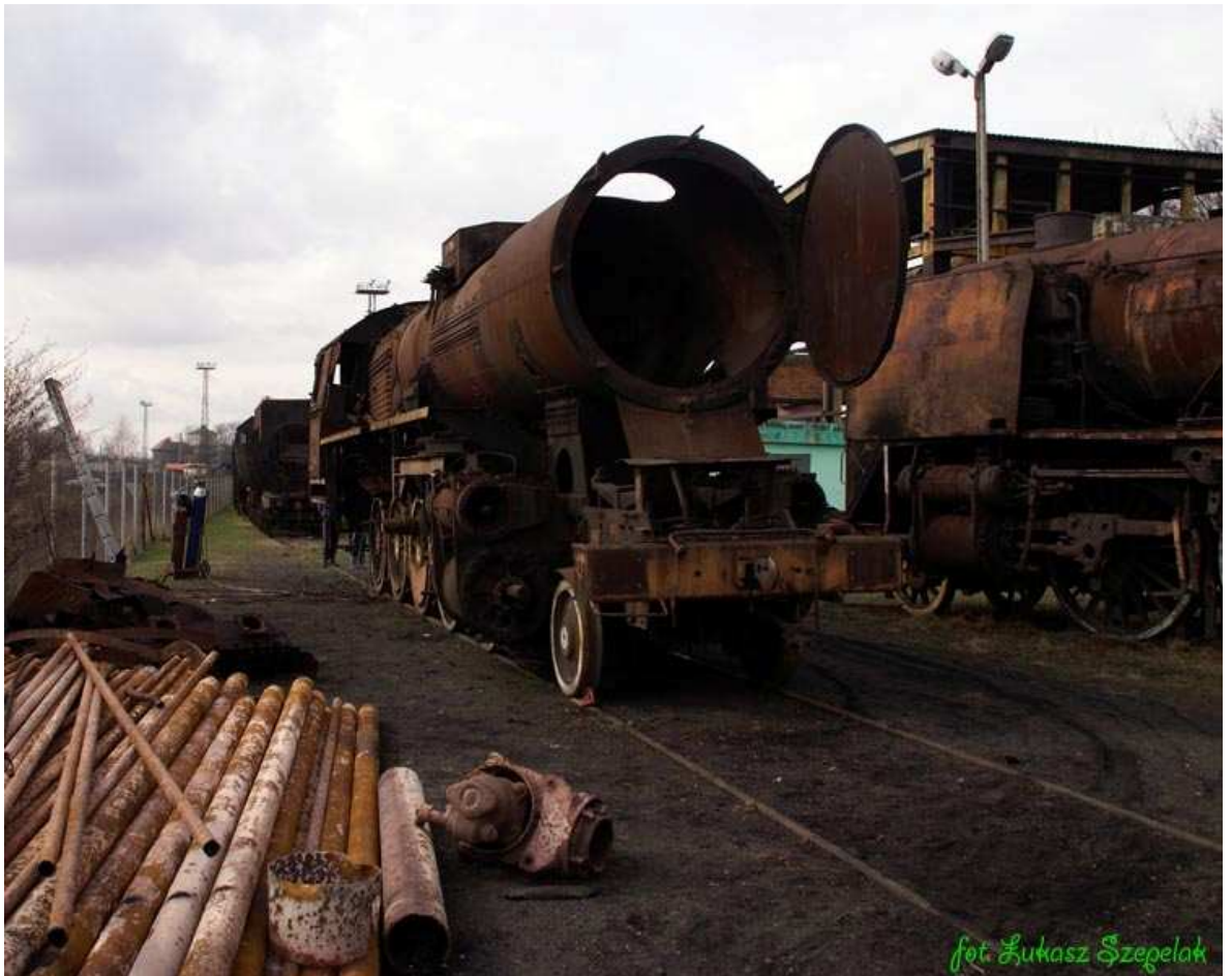
Fot. 6) Parowóz Ty2-1035 na terenie Muzeum Przemysłu i Kolejnictwa na Śląsku w Jaworzynie Śląskiej – marzec 2009 r. Obok parowozu widać wyciągnięte elementy armatury kotła, osprzętu. Te elementy powinny zostać zabezpieczone i zachowane.
