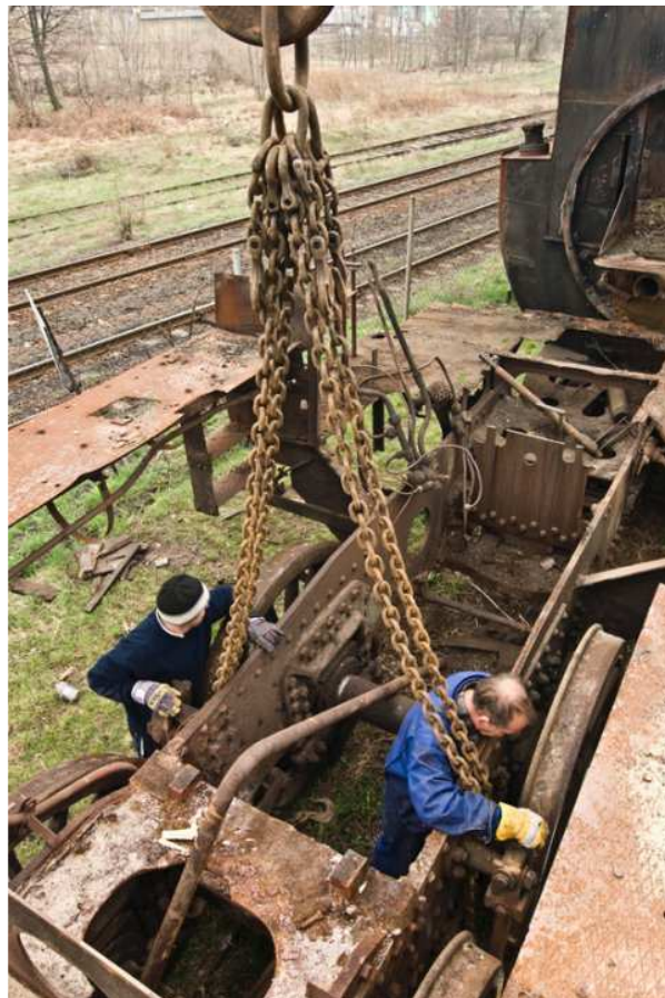
Fot. 2) Podwozie parowozu, bez osprzętu i powycinanymi elementami konstrukcyjnymi. Brak kotła parowozu.. Na terenie Muzeum Przemysłu i Kolejnictwa w Jaworzynie Śląskiej
